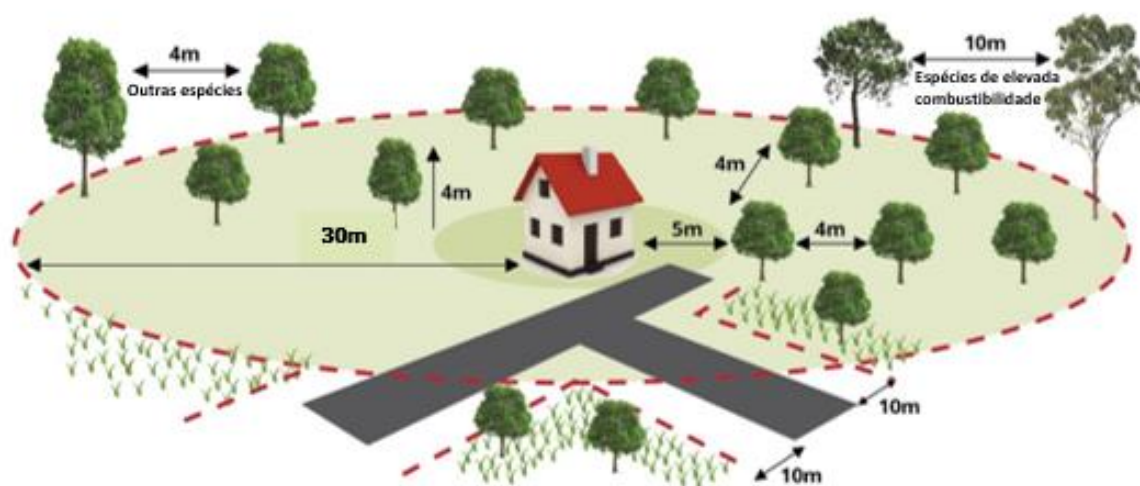
Figura 25 – Esquema exemplificativo da gestão das FGC nas áreas ao redor das infraestruturas (Adaptado de ICNF).
