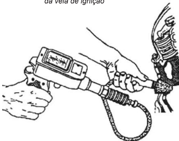
Fig.7.11 – Utilização de um compressógrafo com adaptador
