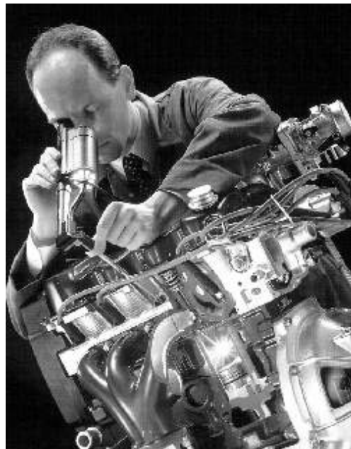
Fig.10.4 – Inspeção de uma câmara de combustão com um endoscópio
