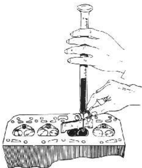
Fig.11.9 – Medição do volume da câmara de combustão
