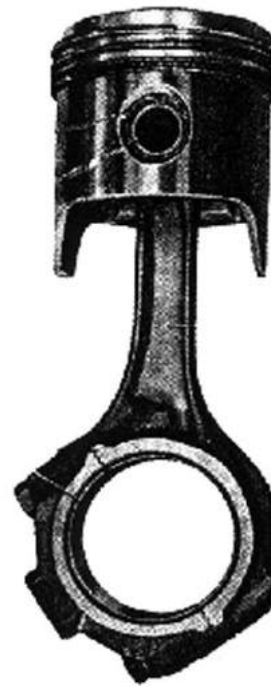
Fig.2.45 – Biela com cabeça inclinada em relação ao eixo longitudinal
